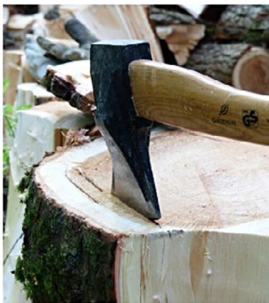
Abb. 36: Bei schwer zu spaltendem Holz werden zuerst Scheite vom Rand abgetragen (Philip Seemann)
