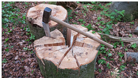
Abb.35: Holz spalten mit Spaltkeil
