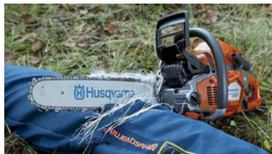
Abb. 3: Säge beim Kontakt mit Schnittschutzhose (Husqvarna)
