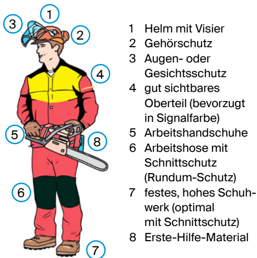
Abb. 2: PSA bei Motorsägearbeiten (SUVA)
